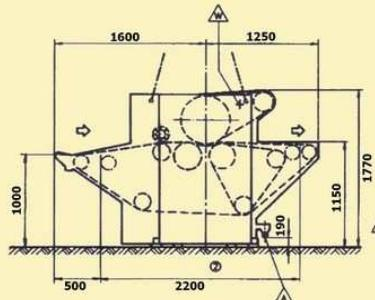
1 Emplacement nécessaire pour le changement des convoyeurs
